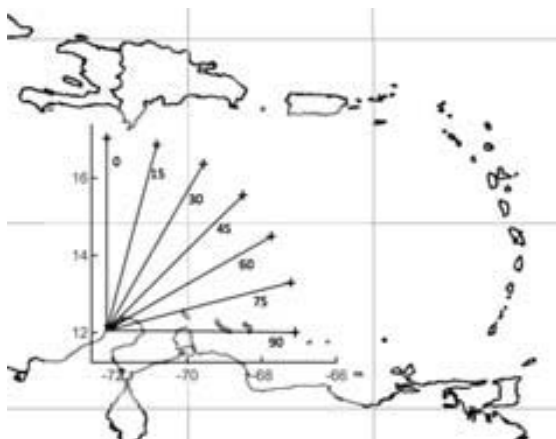
Figura 6: Trayectorias de lanzamiento del cohete con rumbos comprendidos entre 0 y 90 grados a intervalos de 15 grados. Las cruces al final de la línea señalan el lugar de impacto de la primera etapa. Nótese que el valor de la longitud es negativo hacia el oeste.
