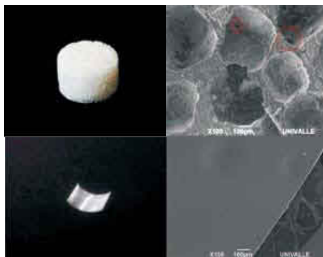
Figura 22. Dispositivos fabricados con las muestras sintetizadas y sus respectivas micrografías SEM.
